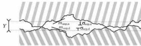
Abbildung 2: Kontaktoberfläche auf mikroskopischer Ebene
