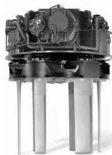
Abbildung 1: Voith Schneider Propeller [1]
