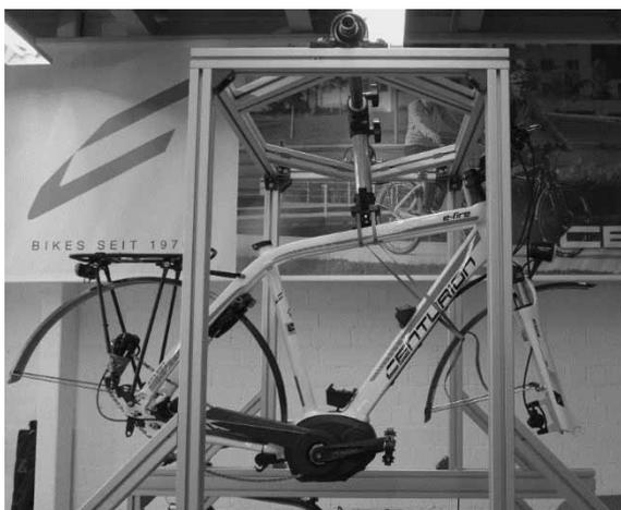
Abbildung 3. Prüfstand Messung Trägheitsmomente
