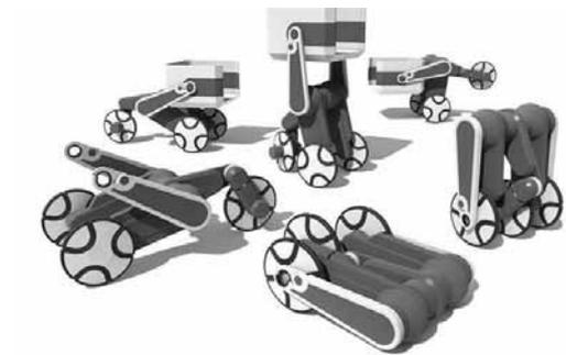
Abbildung 1: Konfigurationen des Serviceroboters [4]
